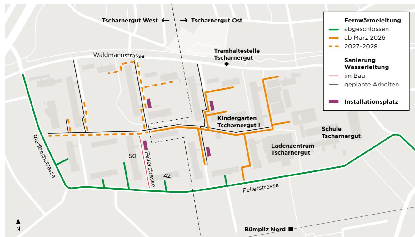
Die Arbeiten werden in mehreren Etappen ausgeführt. Auf der Karte sind die bereits gebauten Leitungen sowie die geplanten Fernwärme- und Wasserleitungen ersichtlich.
